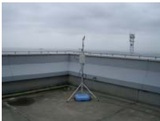
航空機接近検知識別センサー
