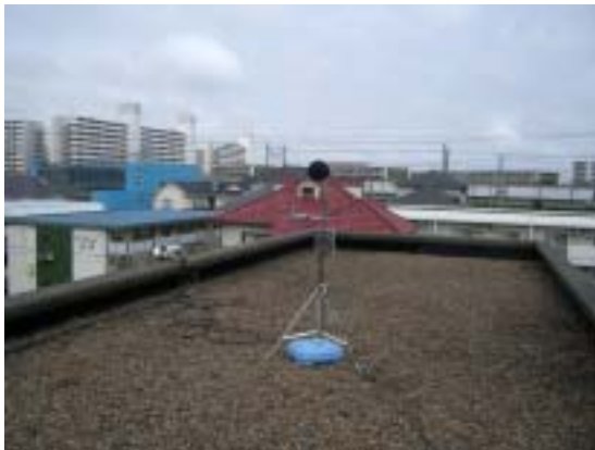
マイクロホン及び全天候防風スクリーン 航空機接近検知識別センサー
