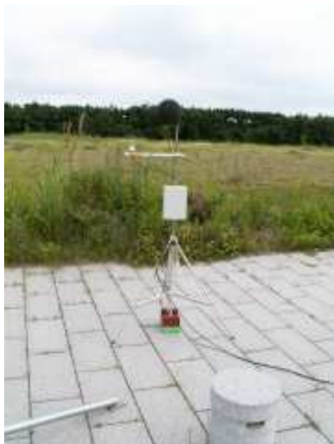
マイクロホン及び全天候防風スクリーン 航空機接近検知識別センサー
