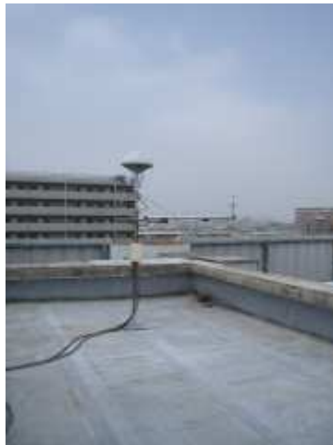
右：航空機接近検知識別センサー 左：航空機最接近検知識別センサー
