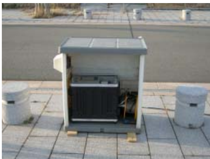
航空機騒音自動測定装置本体
