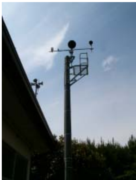
右：マイクロホン及び全天候防風スクリーン 航空機騒音自動測定装置本体 中：航空機音源探査識別装置 左：航空機接近検知識別センサーおよび 航空機最接近検知識別装置
