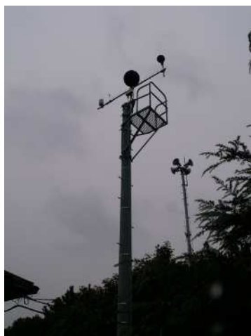
右：マイクロホン及び全天候防風スクリーン 中：航空機音源探査識別装置 左：航空機接近検知識別センサーおよび 航空機最接近検知識別装置
