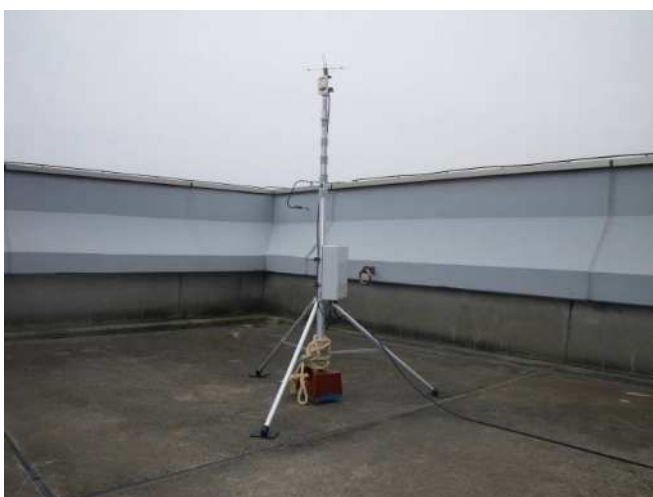
航空機接近検知識別センサー
