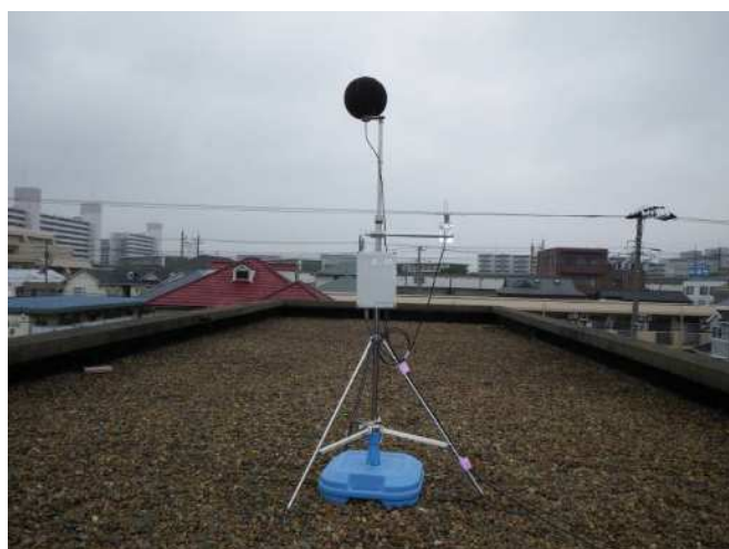
マイクロホン、全天候防風スクリーン 及び航空機接近検知識別センサー
