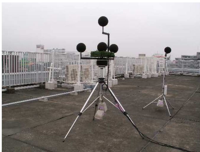
マイクロホン、全天候防風スクリーン及び航空機接近検知識別センサー (写真手前)
