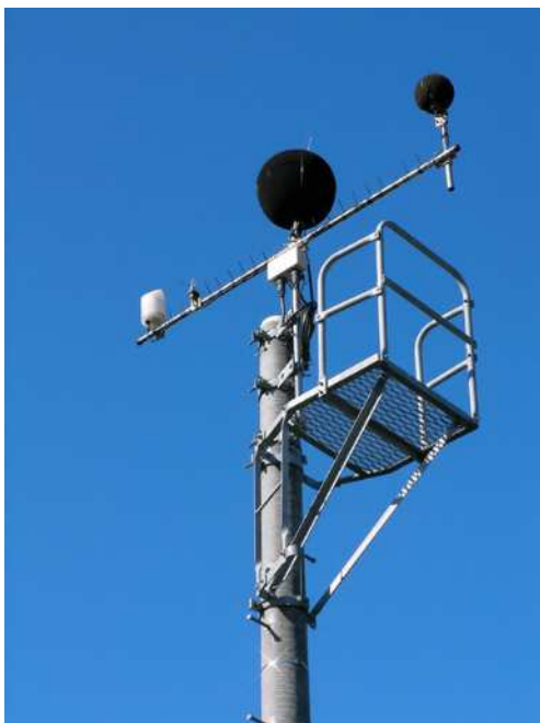
右：マイクロホン及び全天候防風スクリーン 中：航空機音源探査識別装置 左：航空機接近検知識別センサーおよび 航空機最接近検知識別装置
