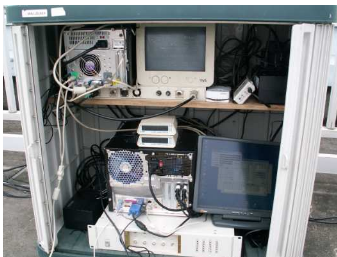
航空機騒音自動測定装置本体(移動局) (写真上段)
