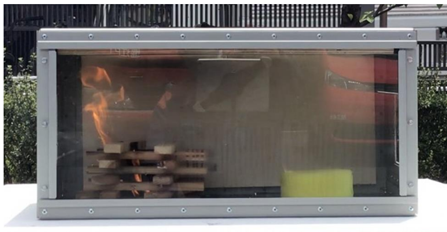
ファイヤーコントロールボックスの燃焼実験状況
