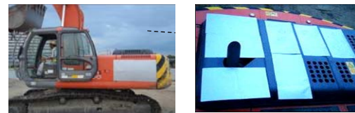
写真-4.5.1 カルムーンシート貼付事例
