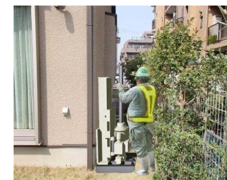
図-4.1.3 開発した小型高圧噴射攪拌機械（楕円改良対応機）
