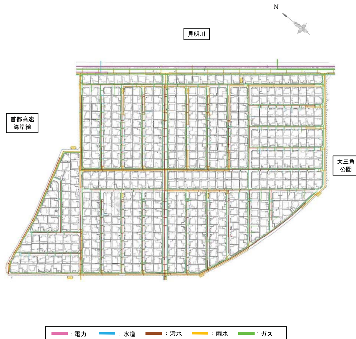
図-1.8 埋設管敷設状況平面図
