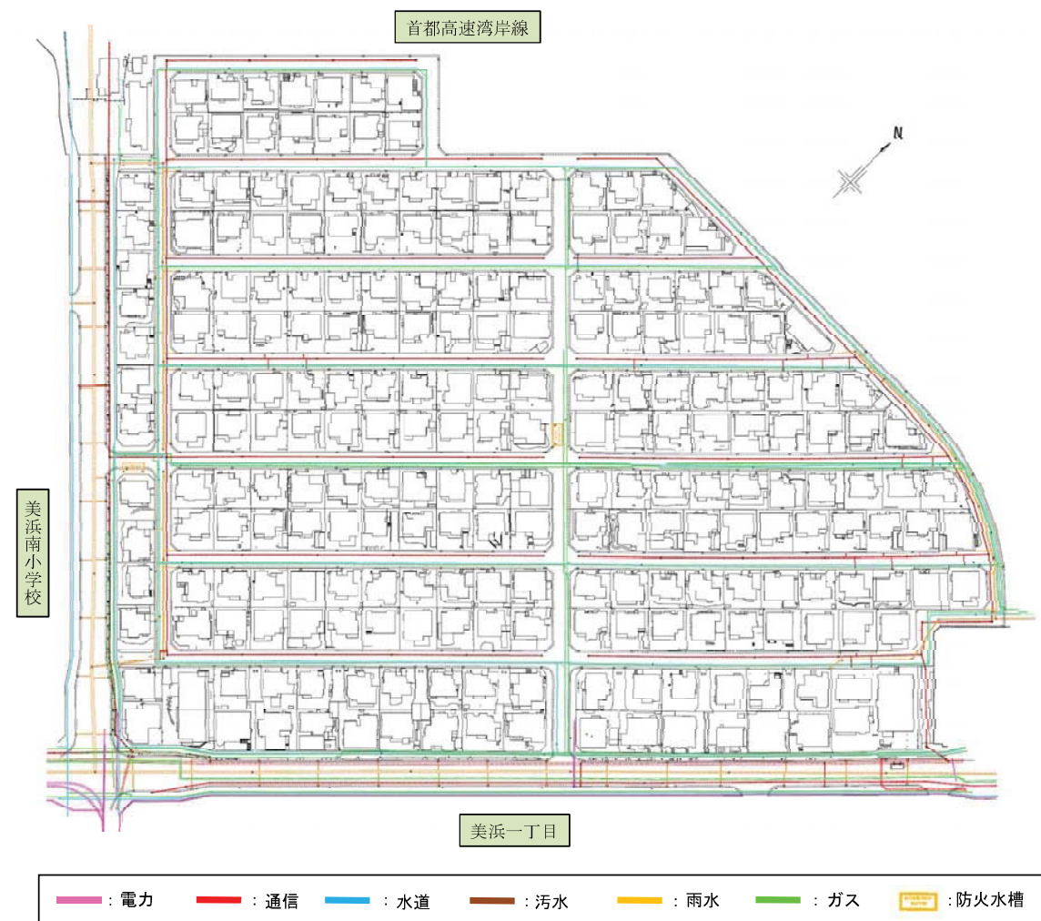
図-1.7 埋設管敷設状況平面図
