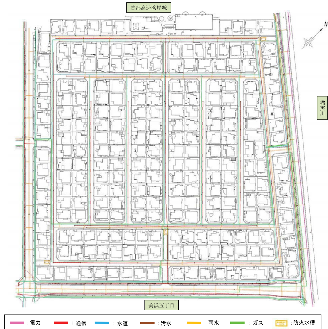
図-1.7 埋設管敷設状況平面図
