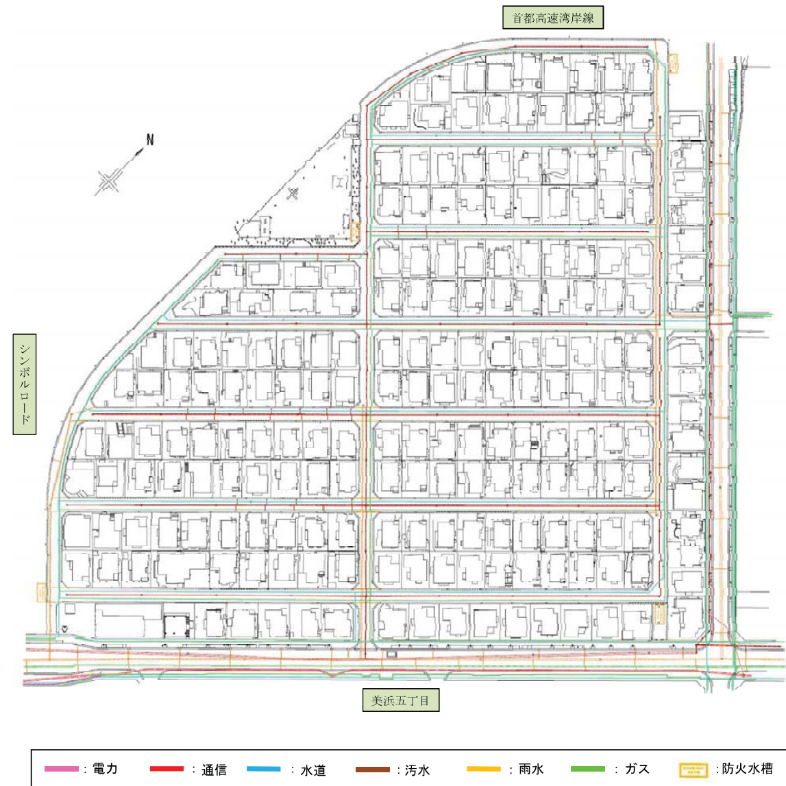
図-1.7 埋設管敷設状況平面図
