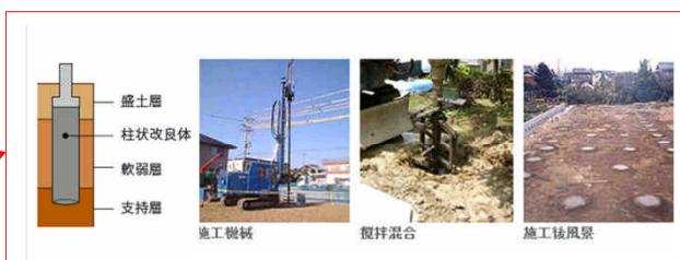
液状化対策の一例 柱状改良工事のイメージ
