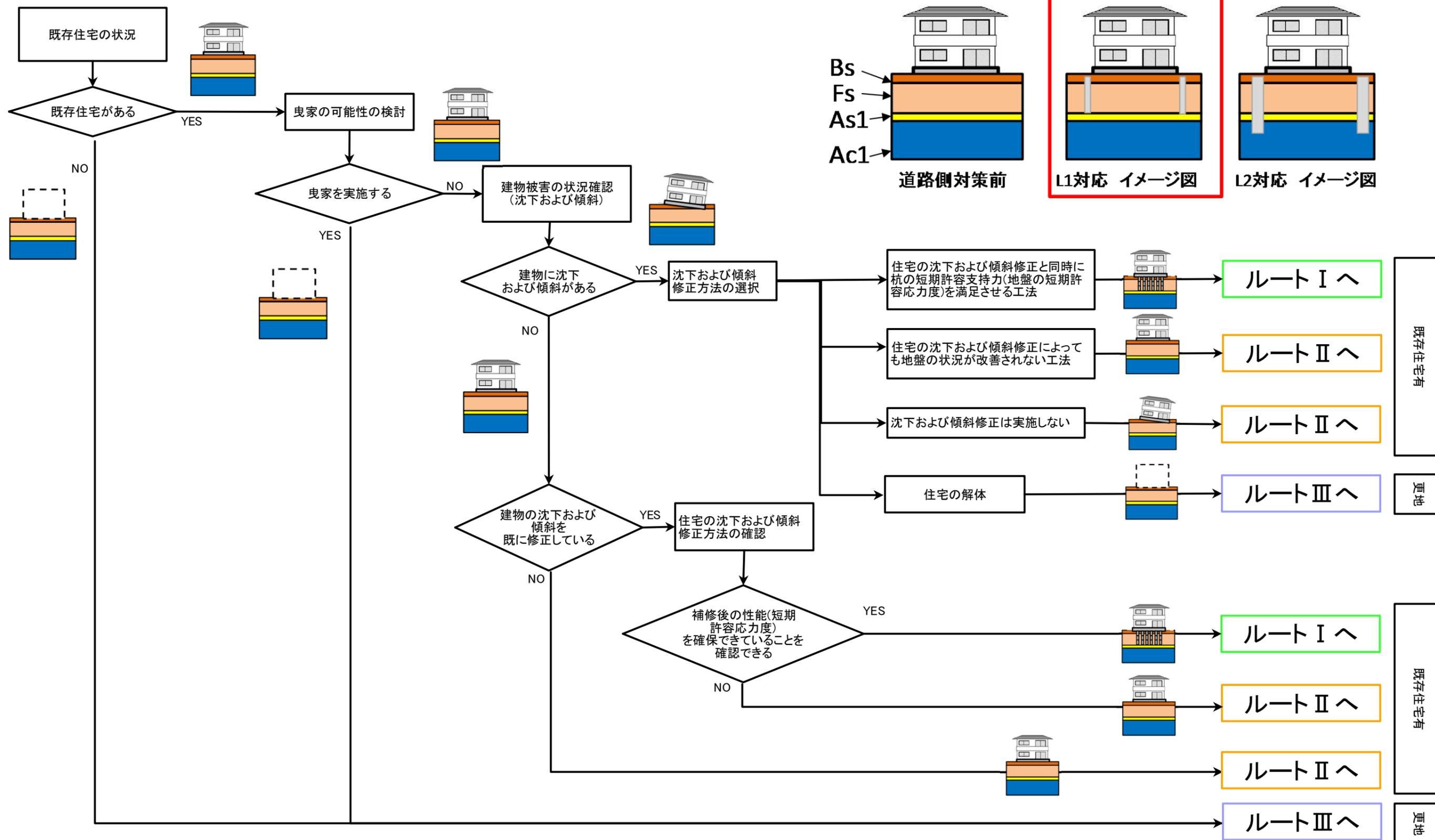
**ルート I** レベル1地震動時に地盤の短期許容応力度もしくは杭の短期許容支持力が確認されている場合(既存住宅有)
