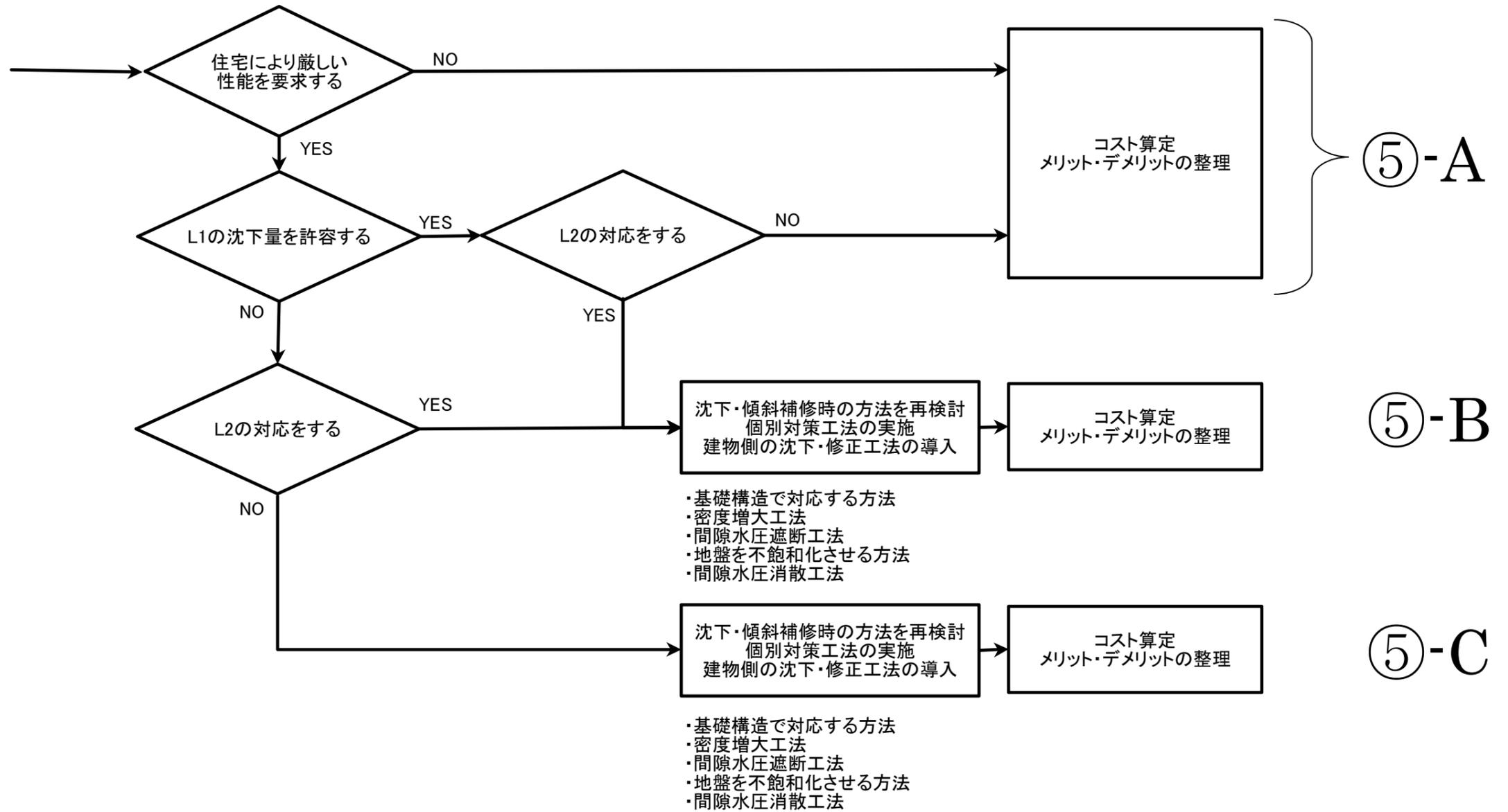
ルートⅡ レベル1地震動時に地盤の短期許容応力度もしくは杭の短期許容支持力が確認されていない場合(既存住宅有)
