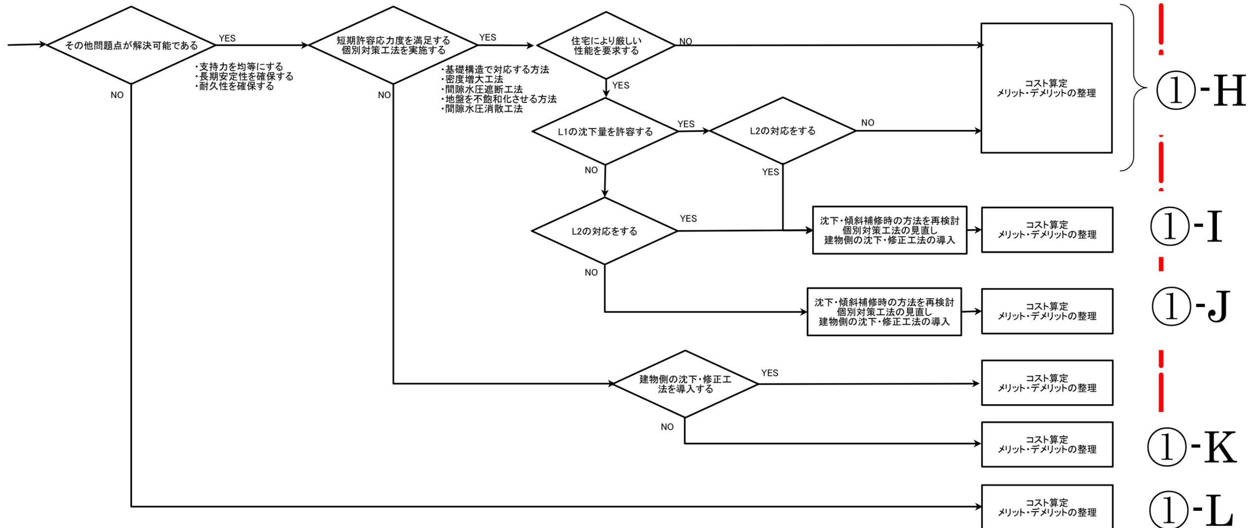
ルートⅣ レベル1地震動時に地盤の短期許容応力度もしくは杭の短期許容支持力が確認されていない場合(更地)
