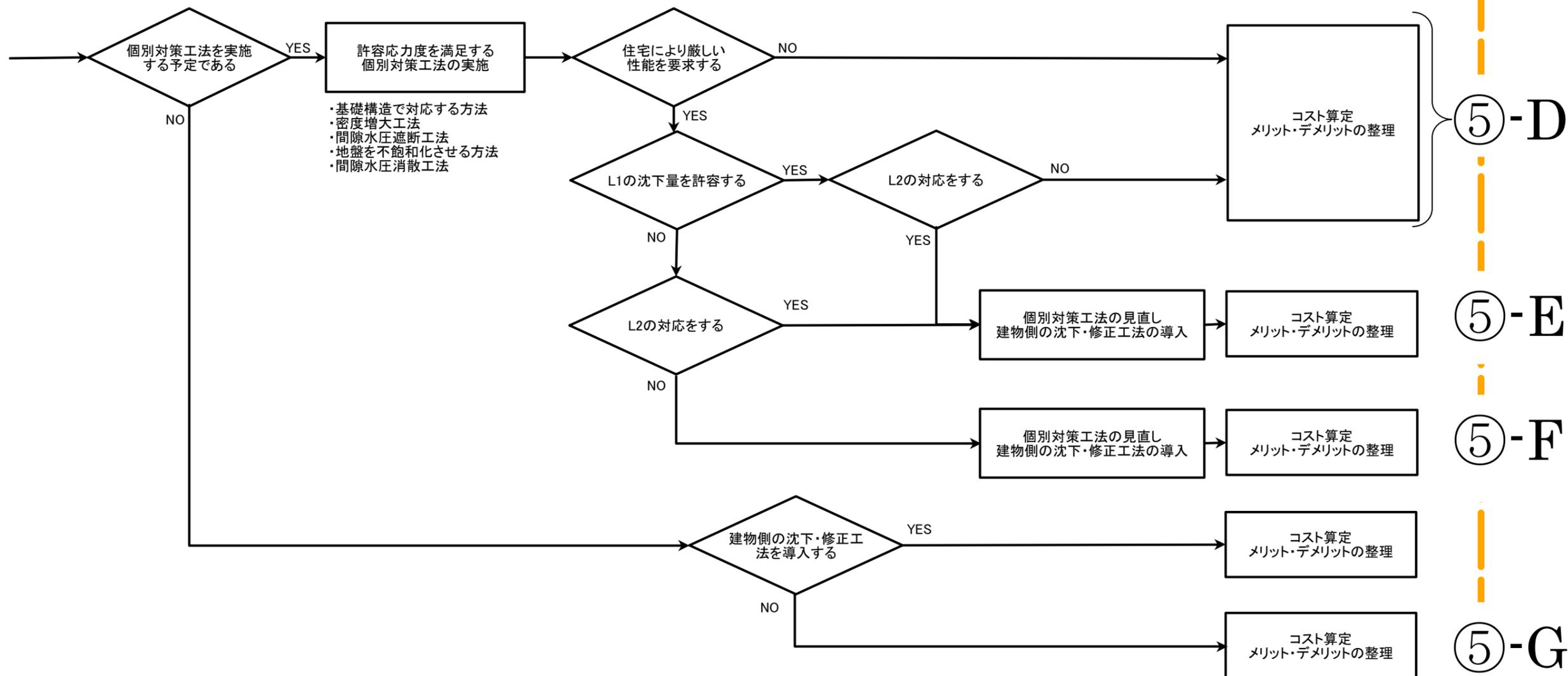
ルートⅢ レベル1地震動時に地盤の短期許容応力度もしくは杭の短期許容支持力が確認されていない場合(更地)
