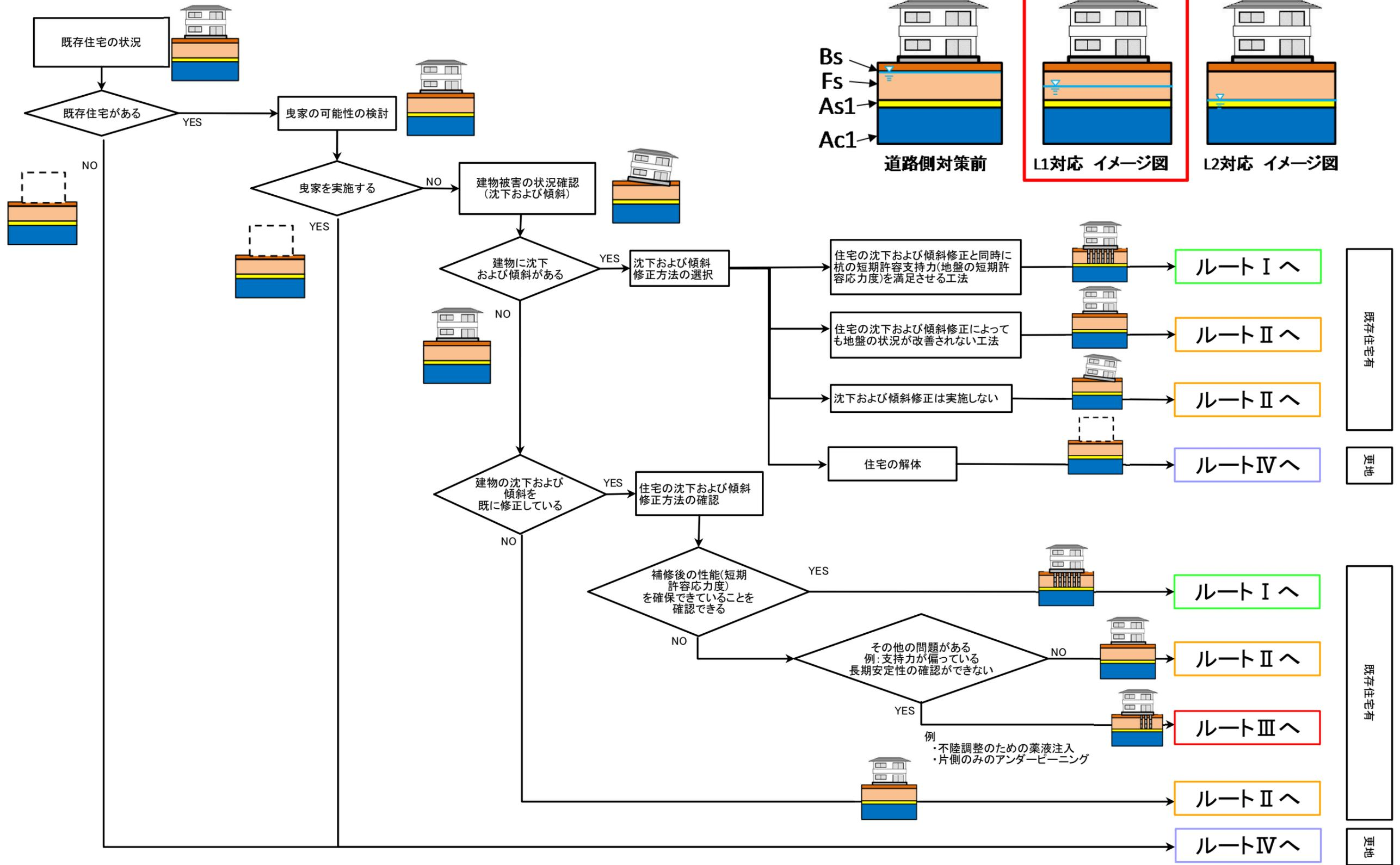
ルート I レベル1地震動時に地盤の短期許容応力度もしくは杭の短期許容支持力が確認されている場合(既存住宅有)
