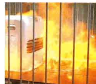
ファンヒーターの前に置いていたスプレー缶が破裂して引火。(再現実験)
