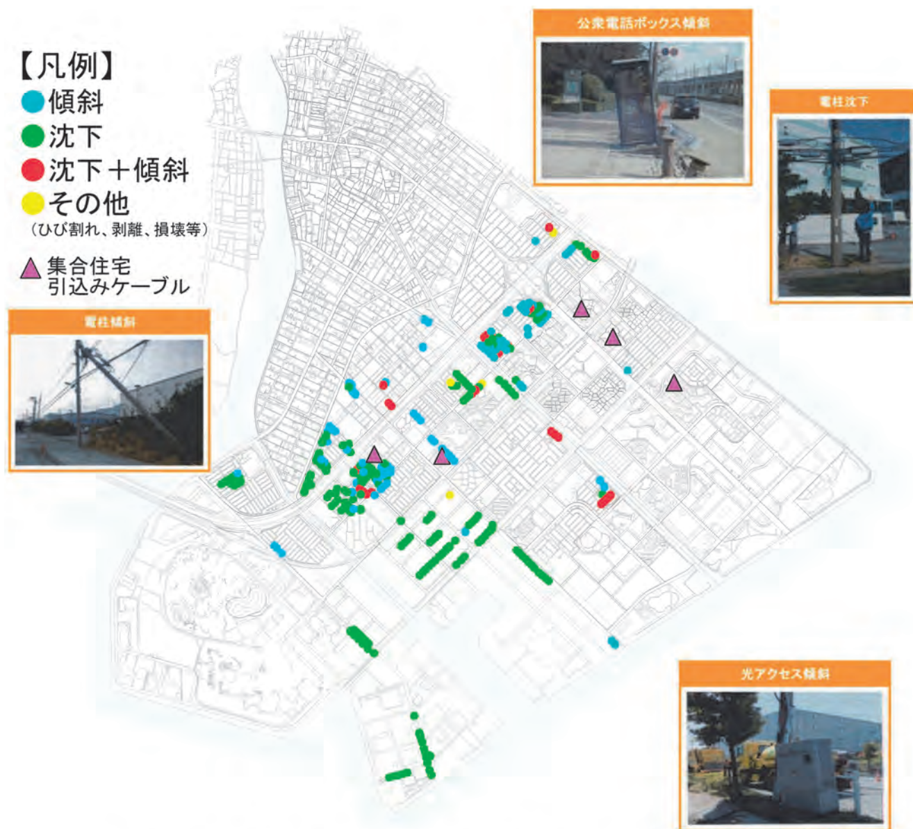
図2.14 NTT東所有電柱被災状況(提供:東日本電信電話株式会社)
