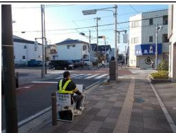
【調査項目】 自動車交通量 歩行者・自転車交通量 信号現示・車線構成
