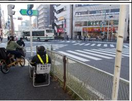
【調査項目】 自動車交通量 歩行者・自転車交通量 渋滞長・滞留長 信号現示・車線構成
