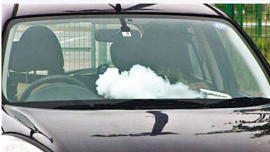
①車内に放置したモバイルバッテリーから白煙が出る様子
