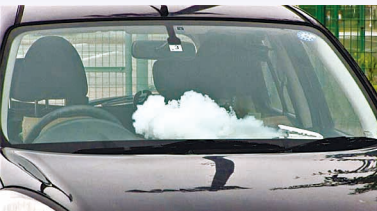
①車内に放置したモバイルバッテリーから白煙が出る様子
