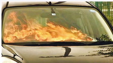
②車内に放置したモバイルバッテリーから火が噴き出る様子
